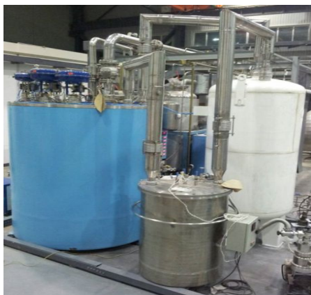
图 2 2kW@20K 制冷机试验系统现场
