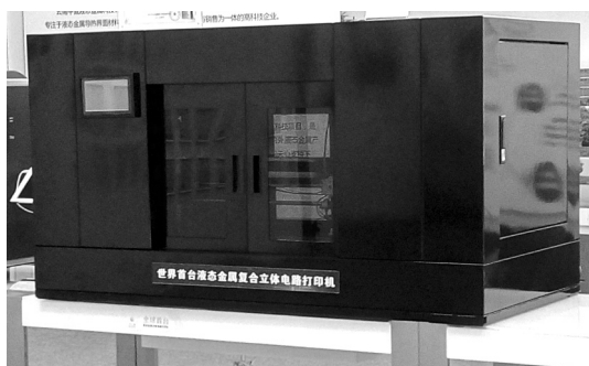
图 5 全球首款液态金属多材料混合 3D 打印机设备
