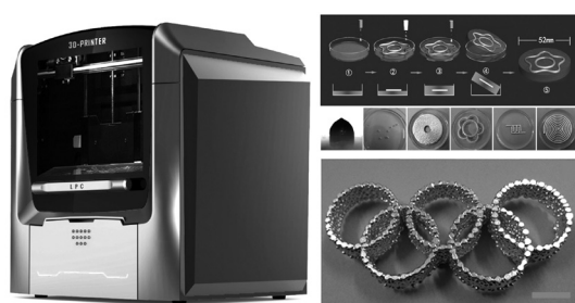
世界首台商用室温 3D 金属打印机及其多功能 墨水复合打印原理与打印制成物件
